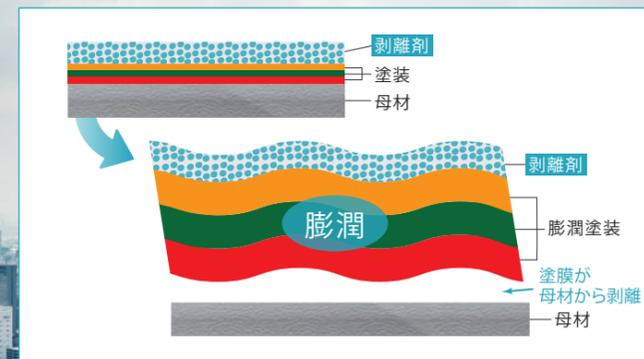
【図-2】架橋高分子鎖の切断による膨潤(模式図)
